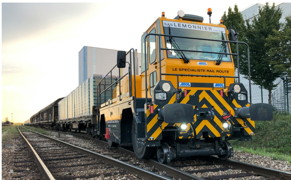
Le développement des dessertes de proximité et du wagon isolé ne peut être mené sans une politique de rénovation ou de création d'installations terminales embranchées (ITE). Sur la photo, VFLI manoeuvre une rame dans l'usine Kronenbourg d'Obernai au moyen d'un nouvel engin rail-route Mol 2444RR loué auprès de l'entreprise Lemonnier. VFLI est présent sur ce site depuis 2001.
