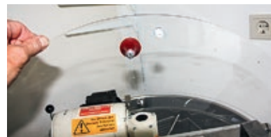
Endschalter an der Schleuder
