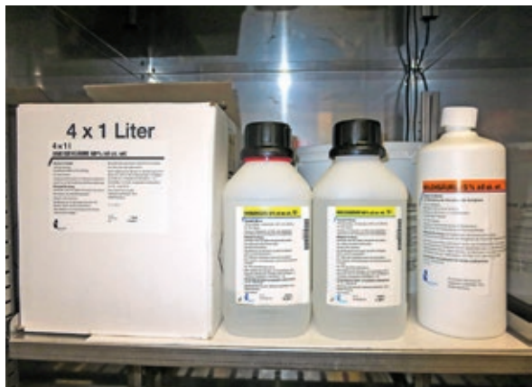
Aufbewahrung von Gefahrstoffen nur im Originalgebinde
