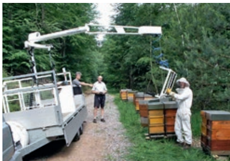
Einsatz eines Ladekrans zum Abladen von Bienenkästen
