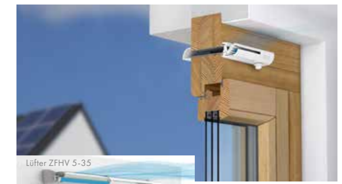
Innenansicht im Querschnitt mit Luftstrom
