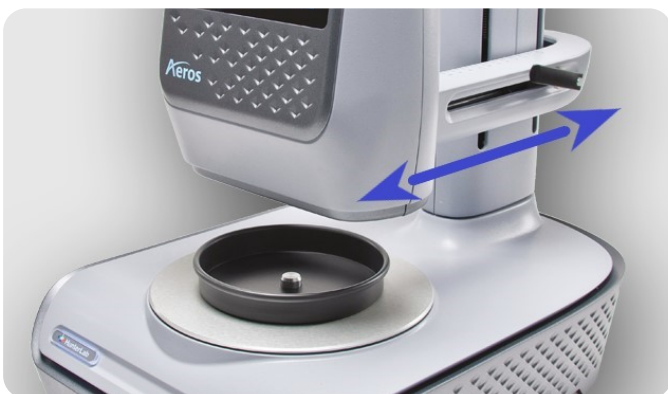
Bild 2: waagrechte Verstellung des Messkopfes
