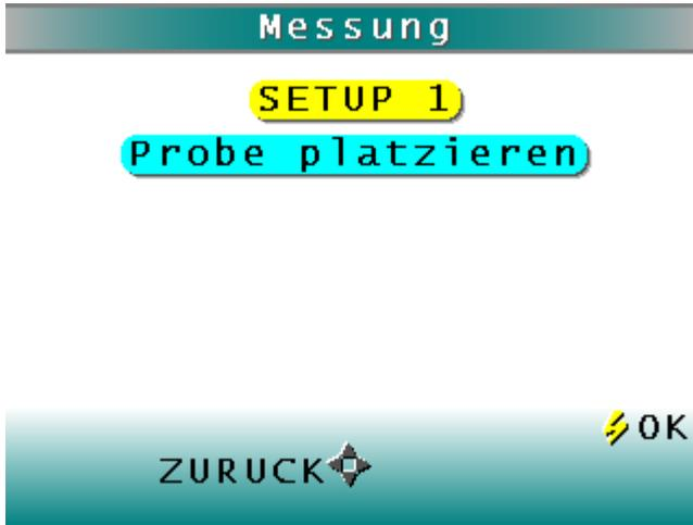
Platzieren Sie den Standard bzw. die Probe plan an der Messöffnung.
