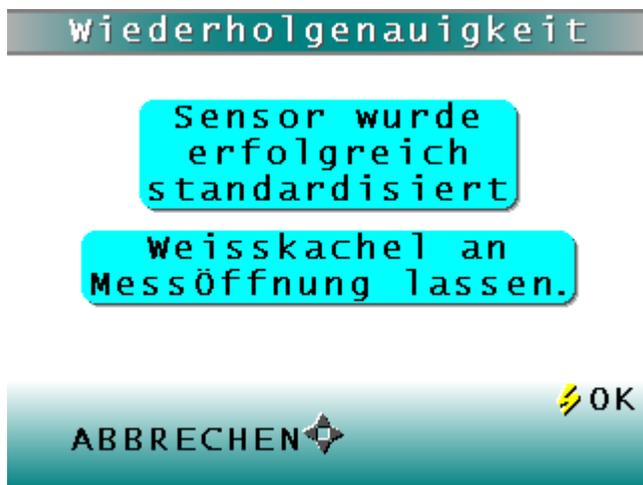
Die Weißkachel muss vor der Messung sauber und trocken sein. Platzieren Sie die Weißkachel plan an der Messöffnung. Über die Blitztaste (,,OK“) wird die Messung ausgelöst. Anschließend werden 20 Messungen durchgeführt.
