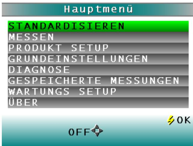
Die Bedienung erfolgt über die Cursor Tasten unterhalb des Displays, die Belegung der Tasten ist jeweils am unteren Rand des Displays dargestellt.
