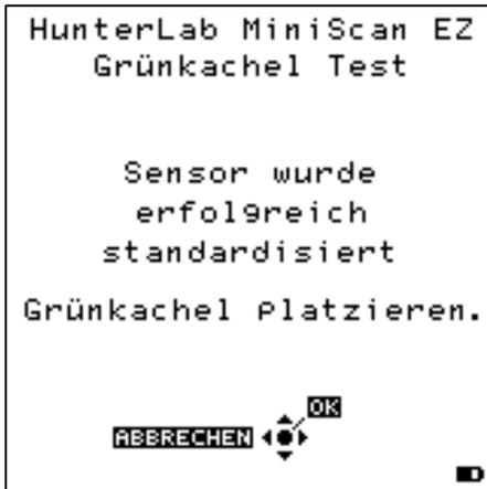
Die Grünkachel muss vor der Messung sauber und trocken sein. Platzieren Sie die Grünkachel plan an der Messöffnung. Über die Blitztaste ● („OK“) wird die Messung ausgelöst.
