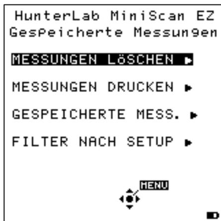
Unter Punkt 1 „**Messungen löschen**“ können alle gespeicherten Messungen gelöscht werden. **Vorsicht: Eine Einzelauswahl ist NICHT möglich.** Der Löschvorgang kann NICHT rückgängig gemacht werden.
