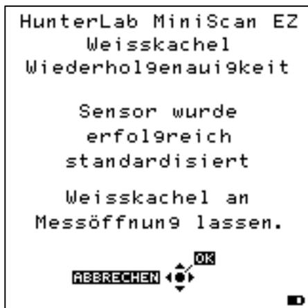
Die Weißkachel muss vor der Messung sauber und trocken sein. Platzieren Sie die Weißkachel plan an der Messöffnung. Über die Blitztaste („OK“) wird die Messung ausgelöst. Anschließend werden 20 Messungen durchgeführt.
