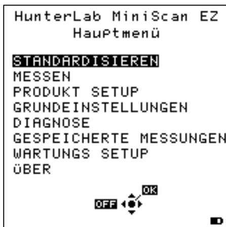
Die Bedienung erfolgt über den Cursor ⬅➡, die Belegung der Tasten ist jeweils am unteren Rand des Displays dargestellt.
