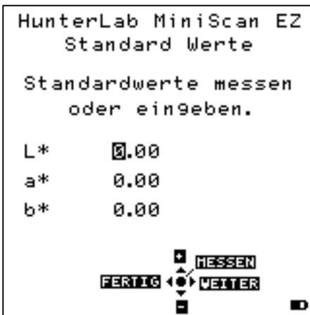
Unter Punkt 6 „**Toleranzen**“ können die Toleranzen für den unter Punkt 5 „Standardwerte“ festgelegten Standard hinterlegt werden. Die Farbskala, Lichtart und Beobachter ergeben sich aus der unter Ansicht 1 eingestellten Parameter (siehe Untermenü Ansichten).
