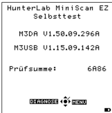
Diese Informationen dienen zur Bestimmung der im Gerät installierten Hilfsprogramme für das Display und den USB Anschluss.
