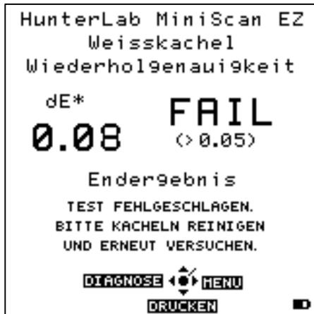
Sollte das Ergebnis wie oben abgebildet mit einem  $DE^* > 0.05$  ausfallen, so wird ein „FAIL“ angezeigt. In diesem Fall sollte der Test wiederholt werden. Ein erfolgreicher Abschluss des Tests endet mit einem „PASS“ wie unten abgebildet:
