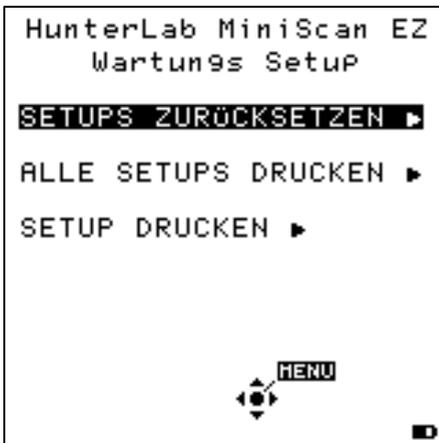
Unter Punkt 1 „**Setups zurücksetzen**“ können über den „Rechts“ Cursor alle Einstellungen der Produkt Setups in die Grundeinstellung zurückgesetzt werden. Es erfolgt eine Sicherheitsabfrage. Diese muss mit der Blitztaste („OK“) bestätigt werden.
