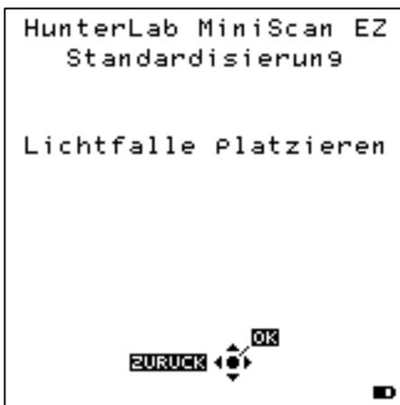
In Schritt 1 muss die Lichtfalle (bei D/8° Modellen) bzw. das Schwarzglas (bei 45°/0° Modellen) plan an der Messöffnung angelegt werden. Bestätigen Sie die Messauslösung mit der Blitztaste
