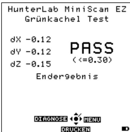
Nach Abschluss erhalten Sie das Ergebnis der Messung. Sie sollten ein „PASS“ erhalten. Erhalten Sie ein „FAIL“ überprüfen Sie bitte erst die Gerätestandards und die hinterlegten Messwerte. Starten Sie dann den Grünkachel Test erneut.
