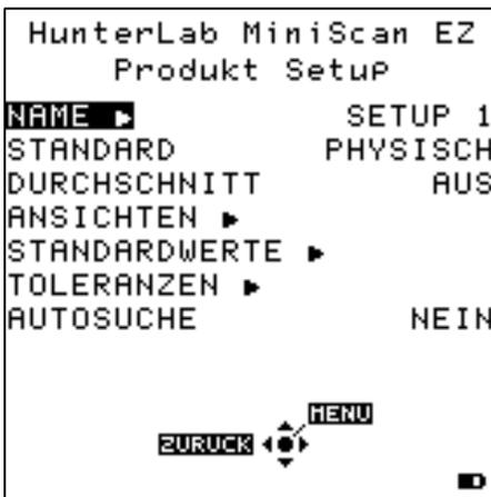
Unter Punkt 1 „**Name**“ kann die Voreinstellung (Setup 1 bis ...) geändert werden. Über den Cursor kann der Name geändert werden. Mit dem „LINKS“ Cursor wird die Eingabe abgeschlossen.
