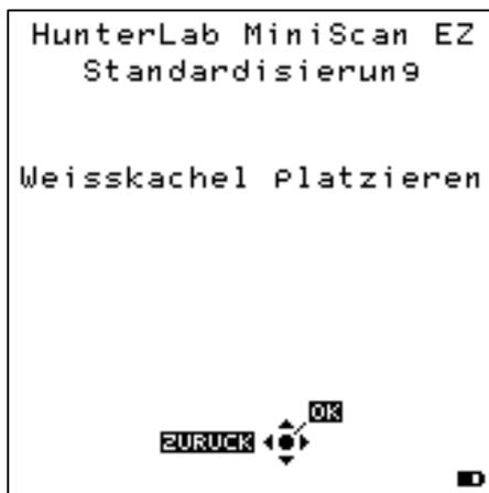
In Schritt 2 muss die Weißkachel plan an der Messöffnung angelegt werden. Bestätigen Sie die Messauslösung mit der Blitztaste (●, „OK“).
