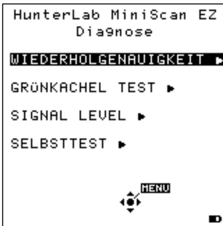
Unter Punkt 1 „**Wiederholgenauigkeit**“ kann die Stabilität des Messgerätes geprüft werden. Bevor die Weißkachel gemessen wird, besteht das Gerät auf eine Standardisierung. Nach Abschluss der Standardisierung erhalten Sie folgende Aufforderung:
