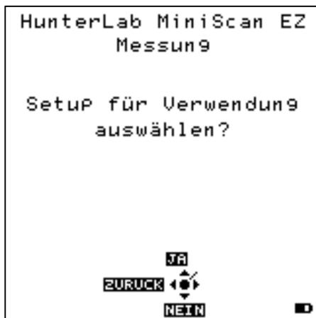
Wählen Sie „NEIN“, wird automatisch das zuletzt verwendete Produkt Setup (siehe Menü **Produkt Setup**) aufgerufen. Wählen Sie „JA“, können Sie das zu verwendende Setup wählen:
