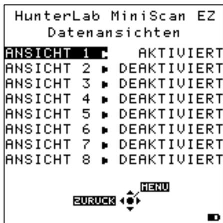
Über den Cursor „RECHTS“ gelangen Sie in die Konfiguration der entsprechenden Ansicht.
