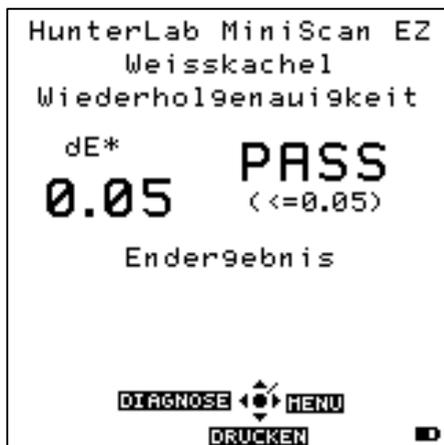
Unter Punkt 2 „**Grünkachel Test**“ kann die farbmetrische Funktionalität des Gerätes überprüft werden. Beim ersten Aufruf dieses Punktes müssen die Werte der Grünkachel eingetragen werden – diese sind auf der Rückseite der Grünkachel zu finden. Bei zukünftigen Aufrufen sind die Werte bereits hinterlegt.
