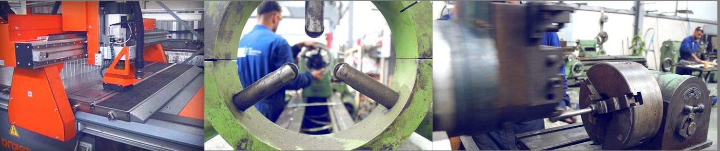
GEI dispone de taller propio para la realización de trabajos tanto internos como externos, disponiendo de tornos de grandes capacidades, fresas, mesa de corte CNC de 6.400x2.000mm. cepillos, equipos especiales de taladrado y corte, contando siempre con una continua evolución de equipamiento y utillaje
