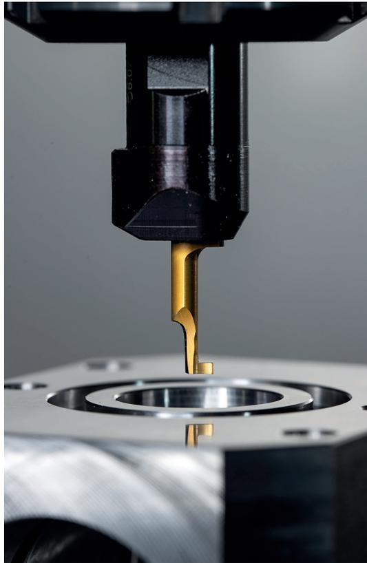
hinaus aber auch sehr gut zum Fräsen von schmalen Nuten und Ausspindeln von Bohrungen“, erklärt der Horn-Außendienstmitarbeiter Jürgen Schmid. Für den Fräsprozess wird zunächst der Axialeinstich/Ring gefräst. Anschließend wird das Supermini-Werkzeug in der Nut in der bestimmten Höhe angestellt. Danach erfolgt die seitliche Zustellung auf die erforderliche Tiefe der Nut. In Folge fräst der Supermini in einer kreisförmigen Bewegung
