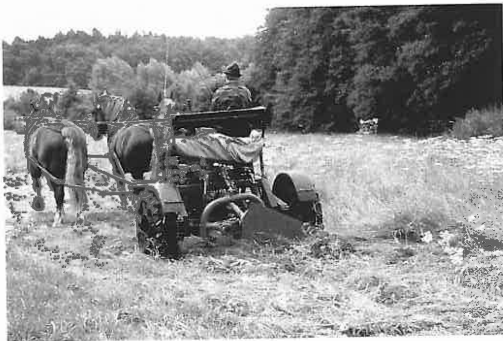
Abb. 24: Beim modernen Pferdeinsatz wird das Doppelmesser-Mähwerk an einem Vorderwagen eingesetzt (Foto E. Stegmaier)
