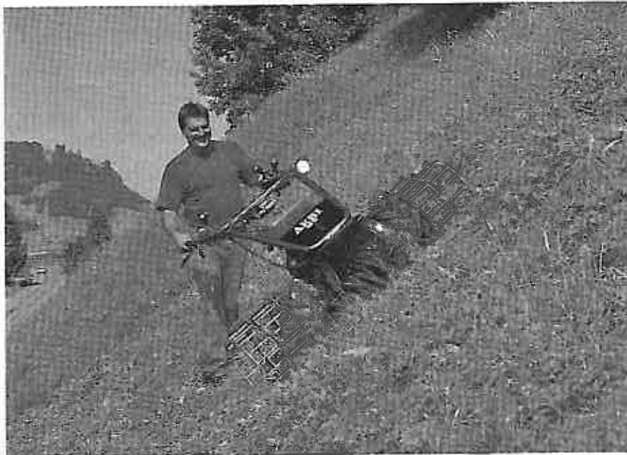
Abb. 22: Der Einachs-Motormäher eignet sich besonders für kleinflächige Mahd und schwieriges Gelände (Hangflächen, Feuchtgebiete etc.) (Werkfoto Aebi)
