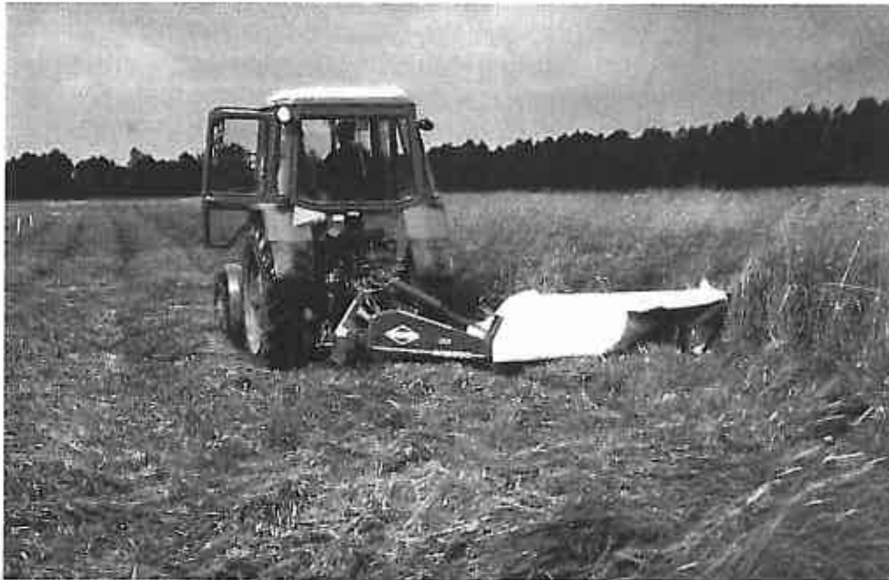
Abb. 7: Mahd mit einem Rotations-Mähwerk (Scheiben- oder Trommelmähdwerk); erst der Blick unter das Schutztuch zeigt die Technik
