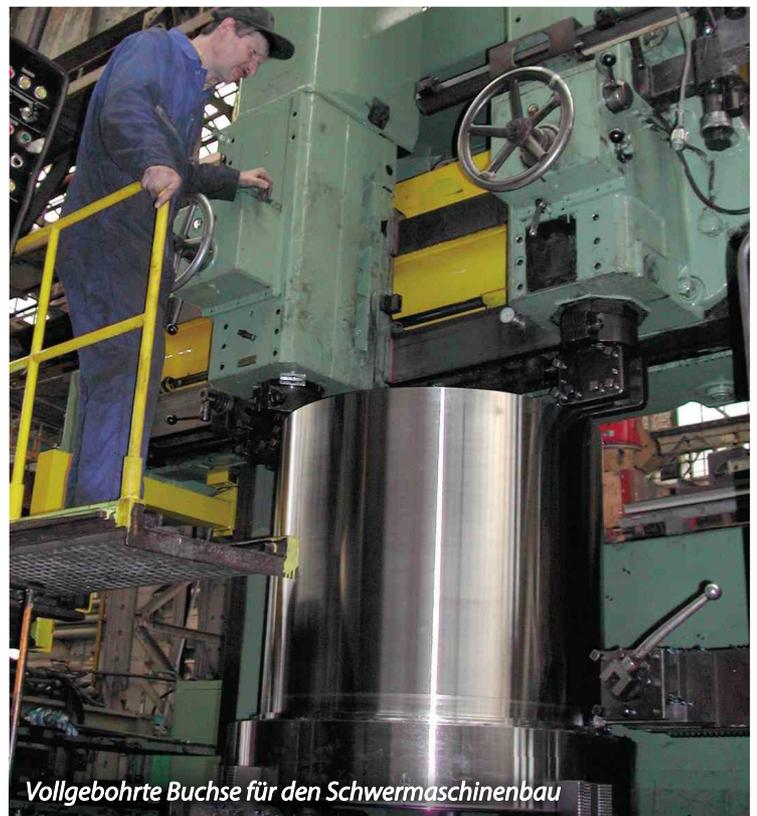
Vollgebohrte Buchse für den Schwermaschinenbau
