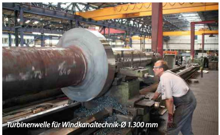
Turbinenwelle für Windkanaltechnik-Ø 1.300 mm
