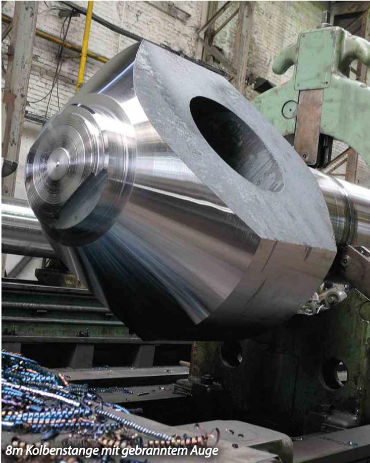
8m Kolbenstange mit gebranntem Auge
