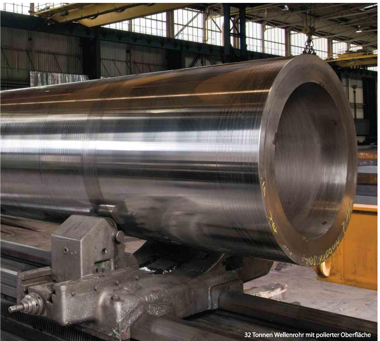
32 Tonnen Wellenrohr mit polierter Oberfläche
