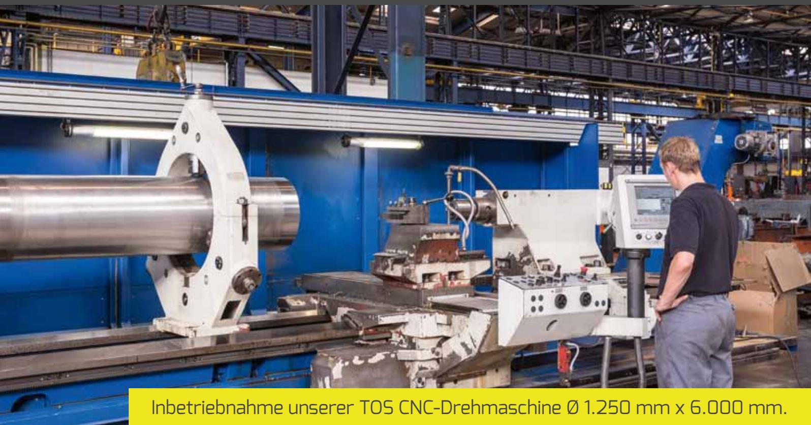
Inbetriebnahme unserer TOS CNC-Drehmaschine Ø 1.250 mm x 6.000 mm.
