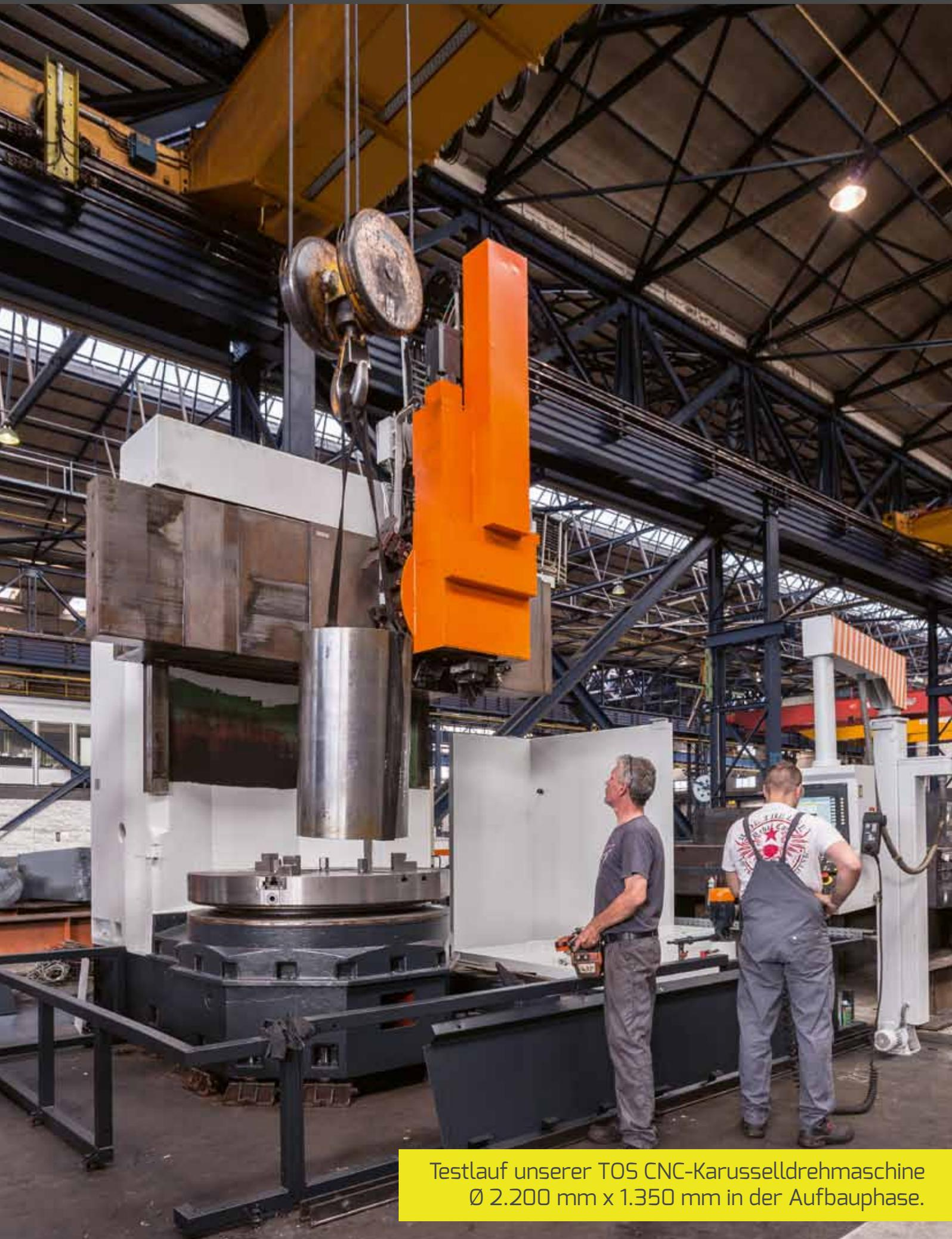
Testlauf unserer TOS CNC-Karusselldrehmaschine
