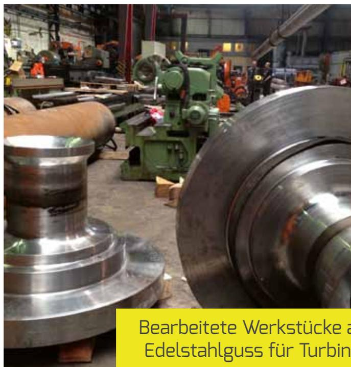
Bearbeitete Werkstücke aus Edelstahl-guss für Turbinen.
