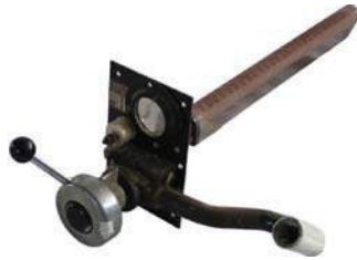
alter STRACHE-Brenner mit Schalthebel-Boschmagnetzündung, dieser Brenner muss grundsätzlich ersetzt werden.
