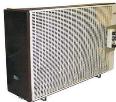
modernisiertes GAMAT-Gerät mit eingebautem Ersatzbrenner, für den Einbau muss ein Ausschnitt in die Verkleidung gemacht werden, die Ausschnittblende wird mitgeliefert.
