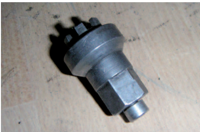
Kronenmutterschlüssel mit Inbusschraube
