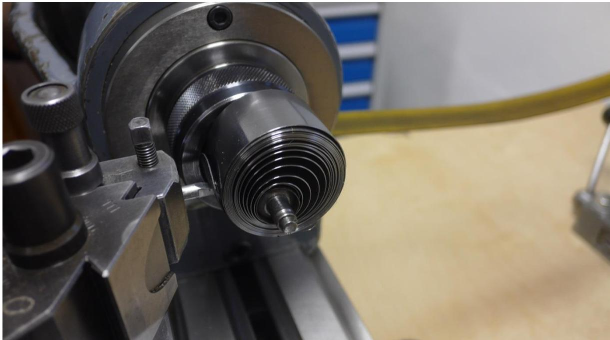
Um die Feder beim Einwinden nicht verbiegen zu müssen, wird die Zugfeder mithilfe der Drehmaschine (durch drehen von Hand) aufgewickelt, um das Federhaus überstülpen zu können.
