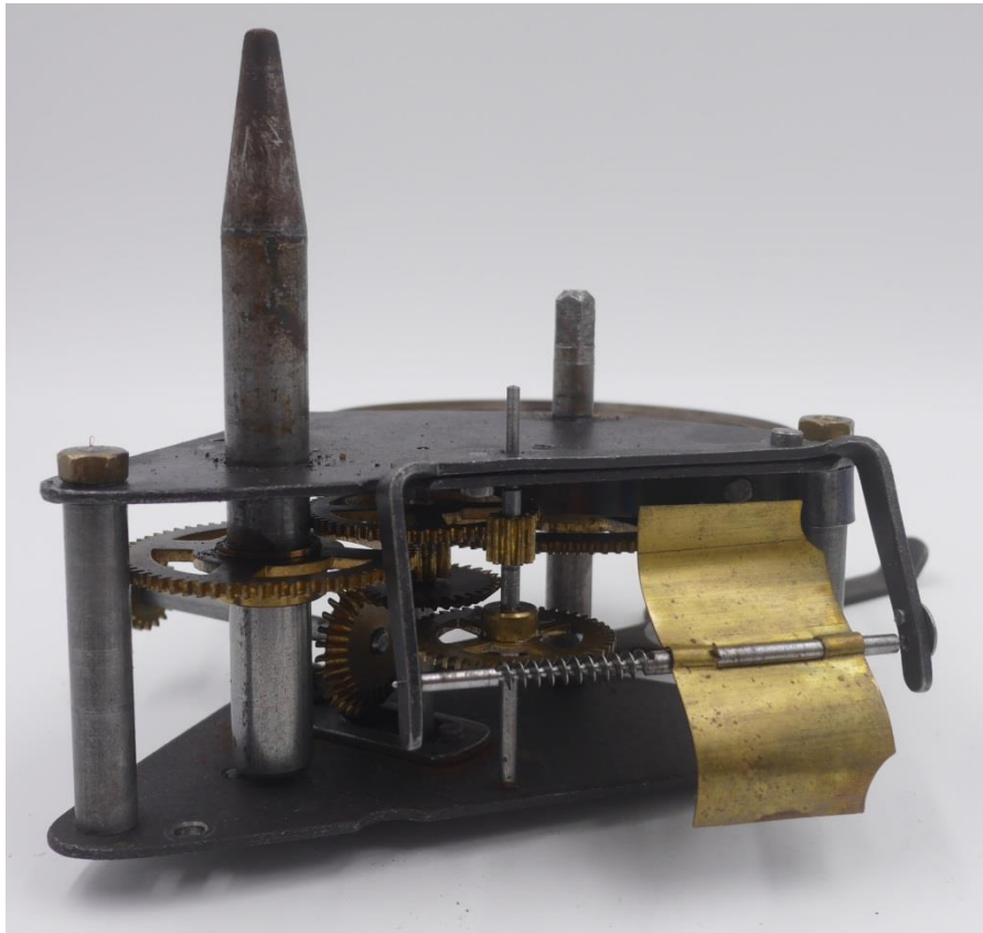
Antriebswerk (die dicke, weit herausragende Welle fungiert als Antrieb für den Weihnachtsbaum)
