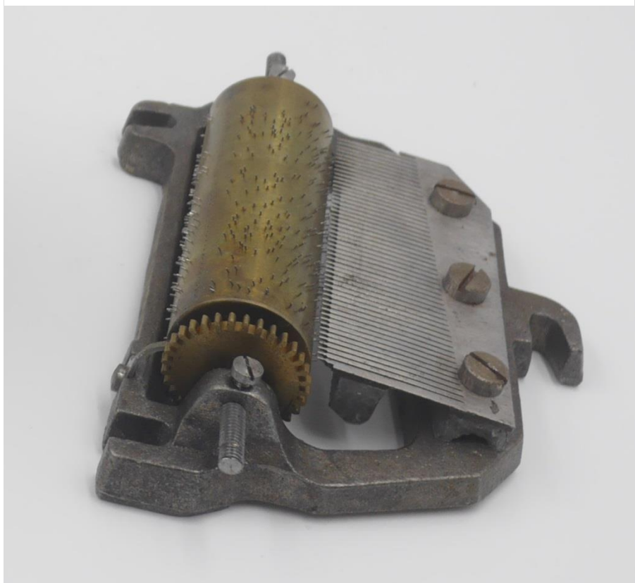
Musikspielwerk, wird über das vordere Zahnrad vom Antriebswerk angetrieben
