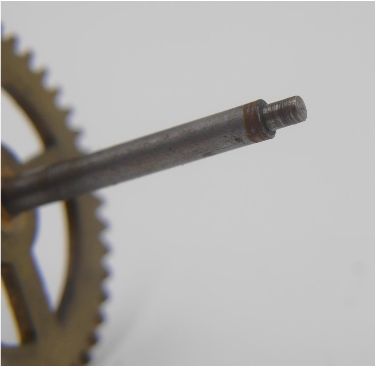
Lagerzapfen im Detail, neben Korrosion weist die Lauffläche erhebliche Riefen auf
