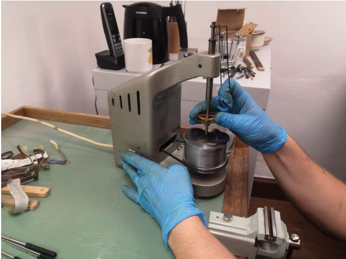
Die Zapfen werden mithilfe einer speziellen Maschine wieder poliert.
