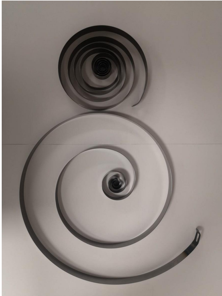
Zum Vergleich: Alte (oben) und neue Zugfeder (unten)
