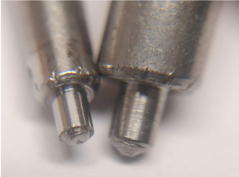
Bild: verschlissener Zapfen mit erkennbaren Riefen (rechts) und polierter Zapfen (links)
