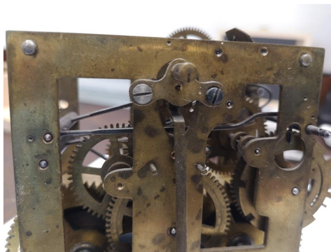
Bild: Zapfen in seinem Lager, aus dem Öl ist eine schwarze Masse geworden
