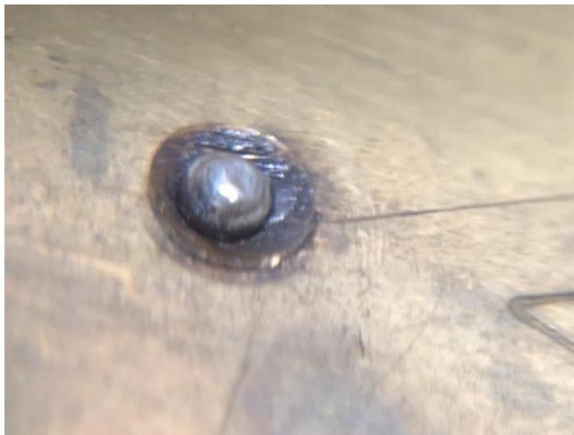
Bild: Zapfen in seinem Lager, aus dem Öl ist eine schwarze Masse geworden
