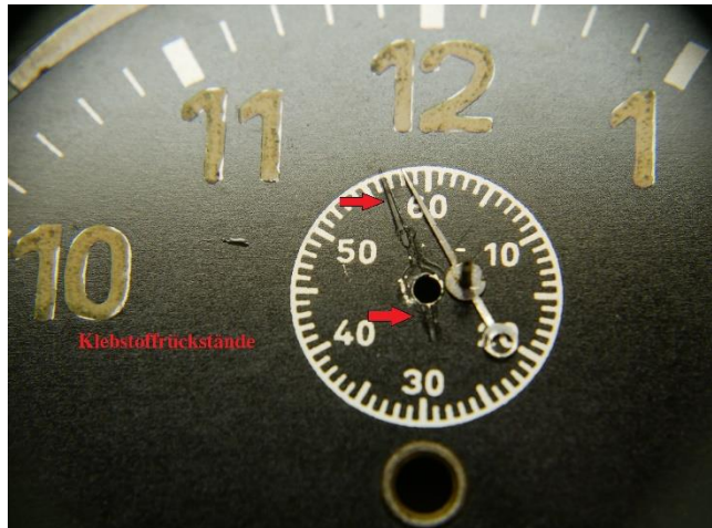
Klebstoffreste unter dem Sekundenzeiger.
