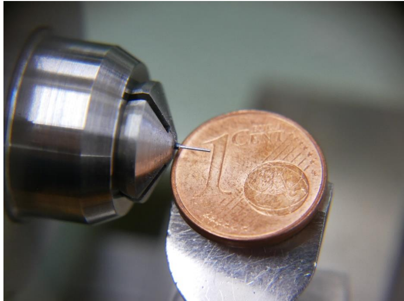
Drehen des neuen Zapfens.
