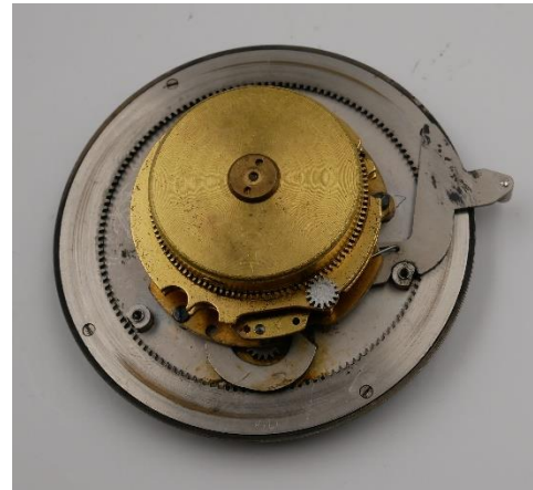
Uhrwerk mit Federhaus und aufgeklebter Messingscheibe.
