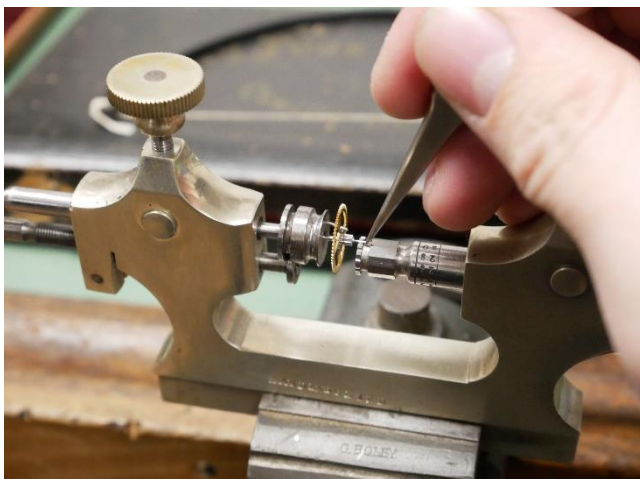
Einsetzen des Zahnrades in den Zapfenrollierstuhl.
