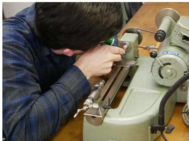
Zentrieren der Mitte mit dem Handdrehmeißel auf der Uhrmacherdrehmaschine.
