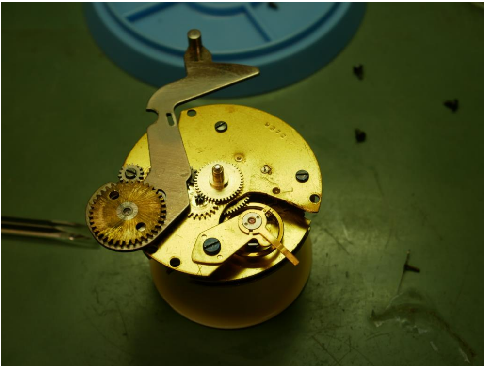
Montage des Uhrwerks.
