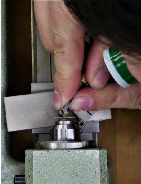
Zentrieren mit dem Handdrehmeißel.
