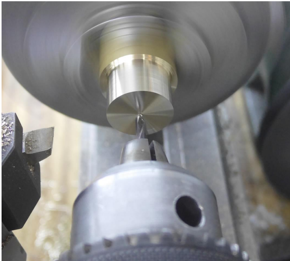
Einbringen der Mittelbohrung: Damit der nachfolgende Bohrer nicht verläuft wird die Mitte des Rohlings exakt zentriert...
