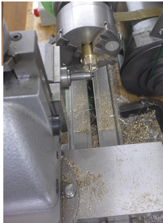
Vertikalsupport mit eingesetztem Fräser während dem Ausrichten.
