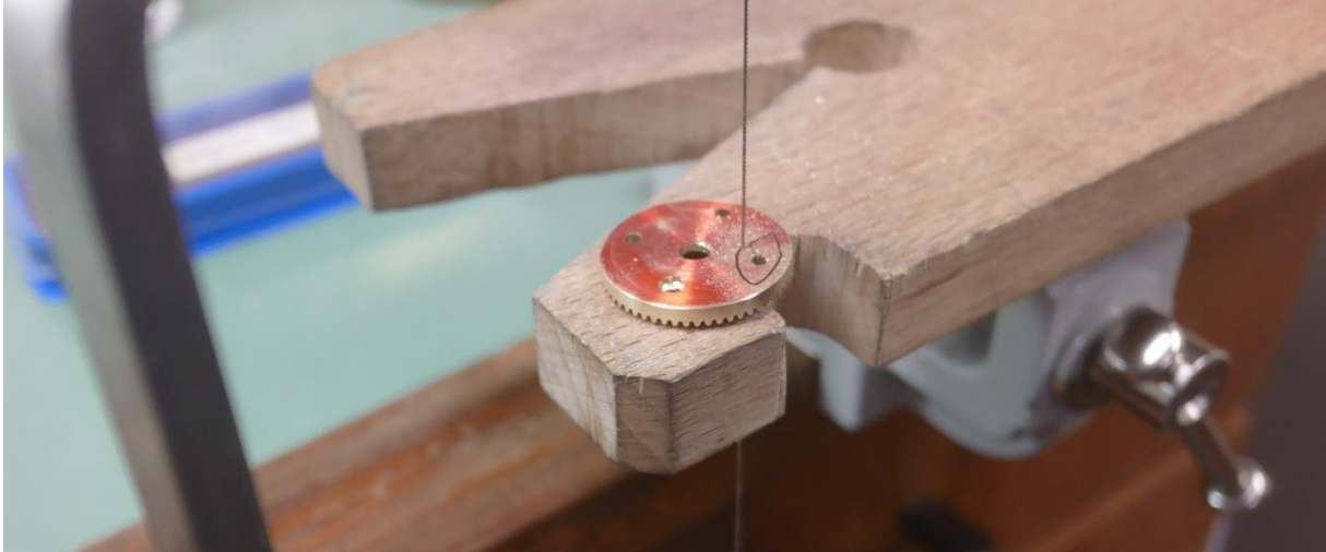
Aussägen der Schenkelung mit der Laubsäge. Die Bohrungen dienen dazu, das Sägeblatt einfädeln zu können.
