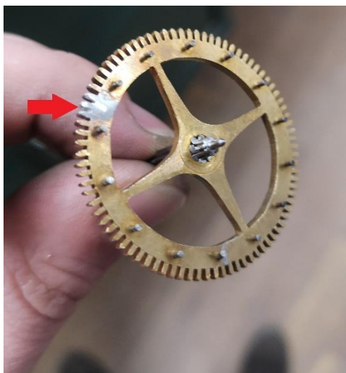
Hier wurden drei Zähne durch Lötzinn ersetzt [sic!] Die Zähne bestanden vollständig aus Lötzinn.
