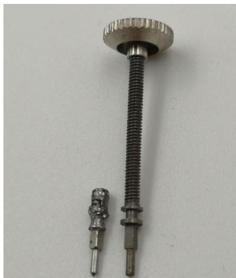
Links: Aufzugswellenstück als Zapfenersatz, daneben zum Vergleich eine Aufzugswelle aus einer Armbanduhr
