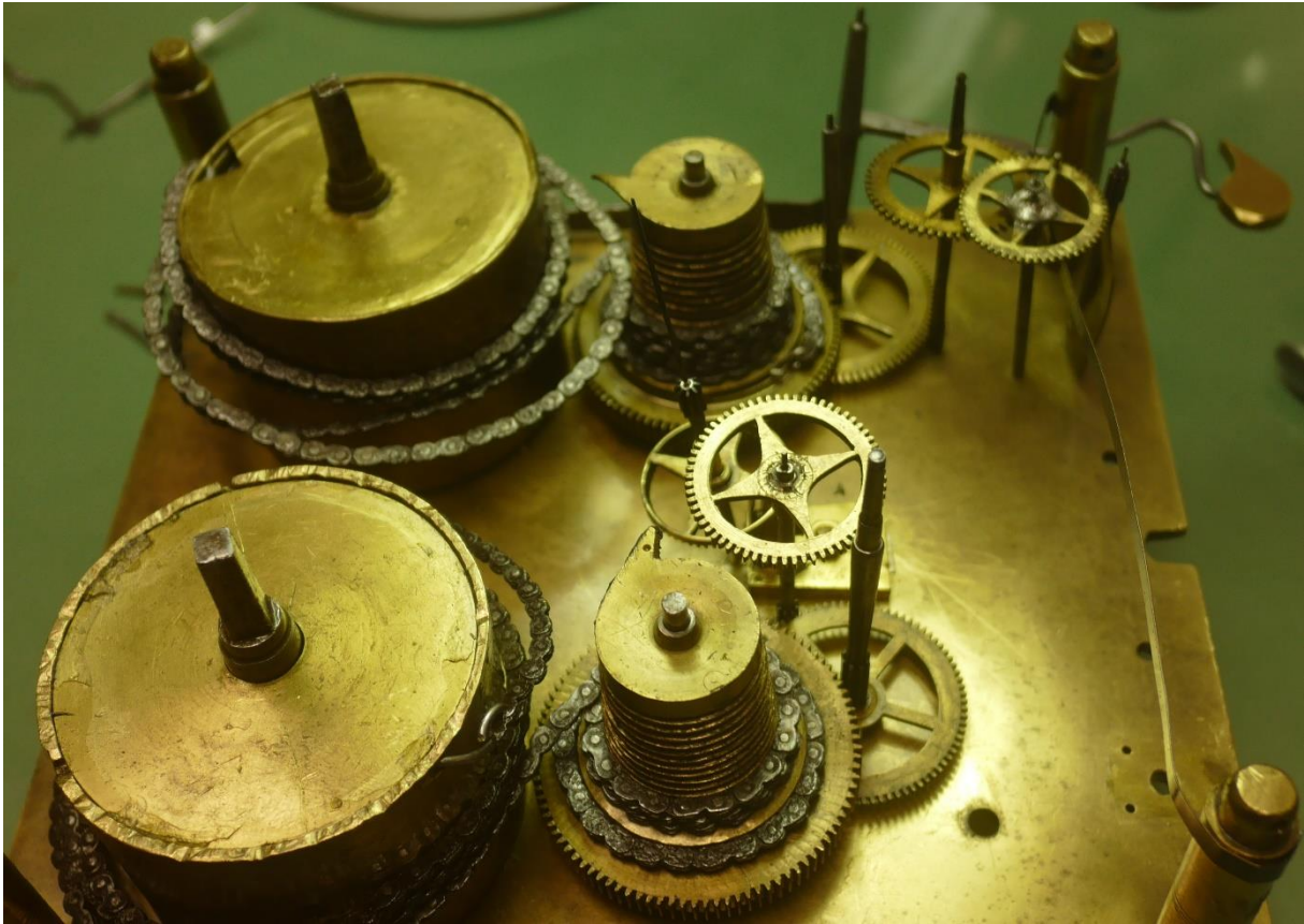
Typisch englischer Verkaufbau mit Kette, Schnecke und Spindelhemmung
