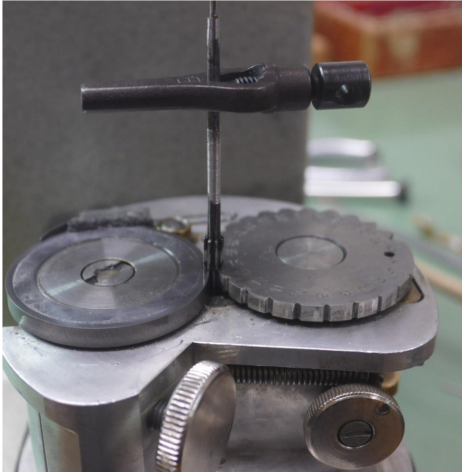
Zapfen rollieren im „Rollimat“. Das auf die Welle geklemmte „Drehherz“ dient zum Halten der Welle.
