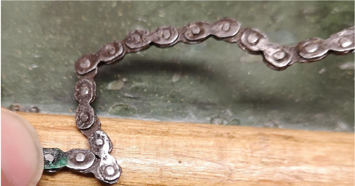
Kette mit teilweise beschädigten / losen Nietverbindungen
