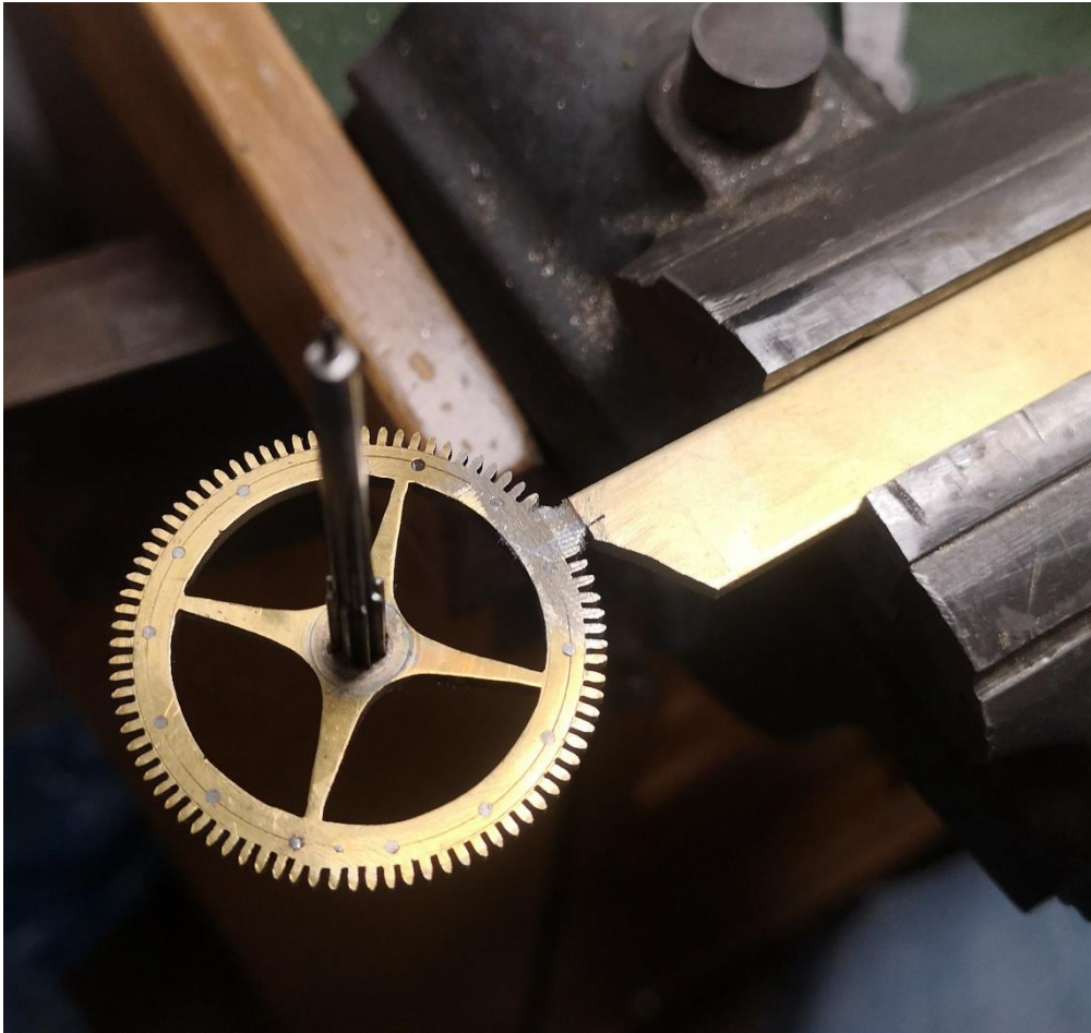
Einpassen des Messingbleches
