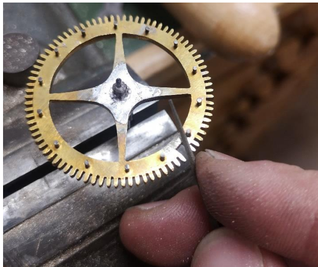
Entfernen der Lötzinnreste
