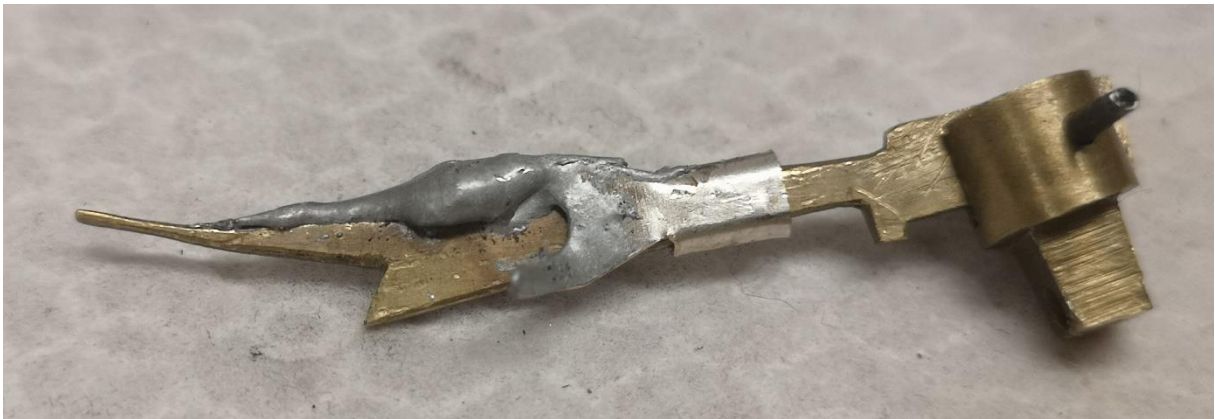
Hier wurden nicht nur Unmengen an Lötzinn aufgebracht, sondern sogar ein Steckverbinder aus dem Elektronikbereich aufgelötet, wozu ist unklar.
