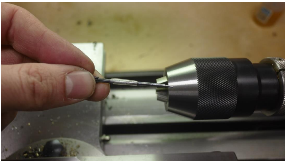
Um die Welle beim Spannen im Bohrfutter vor Macken zu schützen wurde diese mit Klebeband umwickelt.
