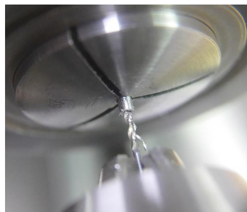
... und anschließendes Bohren
