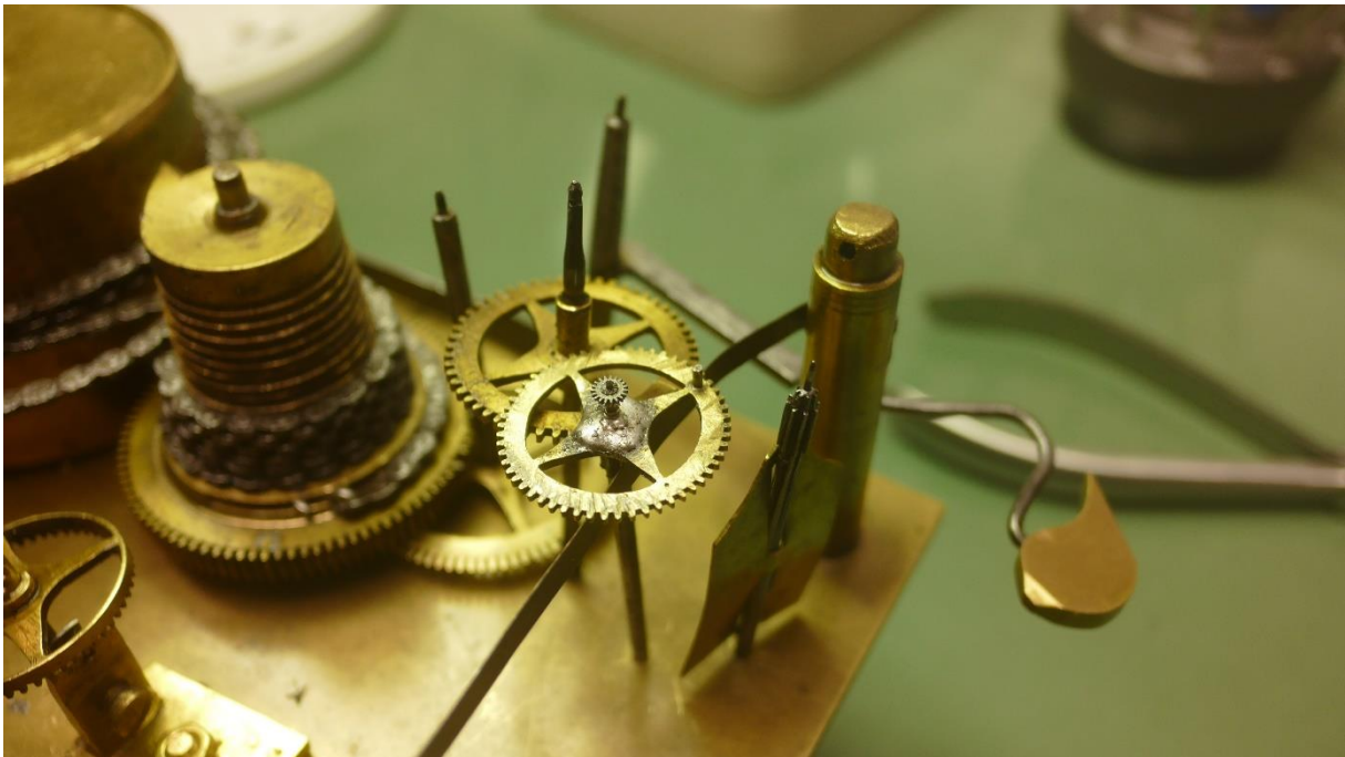
Am Warnrad des Schlagwerkes war ein Kleinuhrzahnrad über den Zapfen geschoben.
