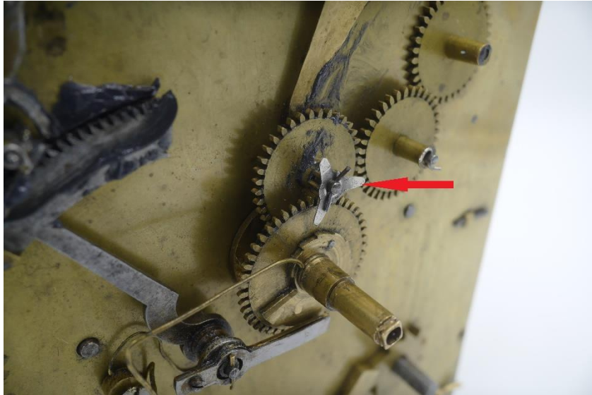
Zeitlich nicht zur Uhr passende Friktionsfeder, überdies noch falsch montiert
