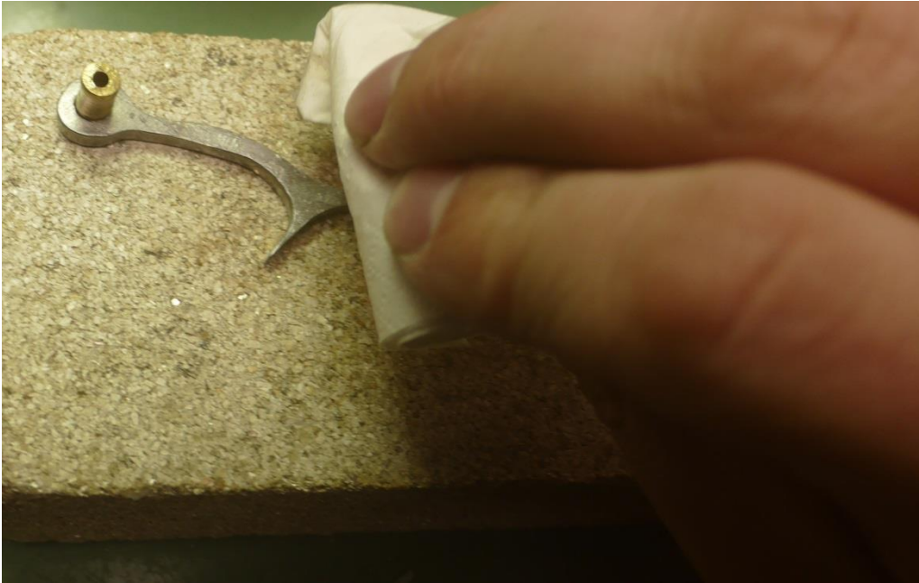
Entfernen des überschüssigen Waxes, sodass eine homogene Struktur zurückbleibt
