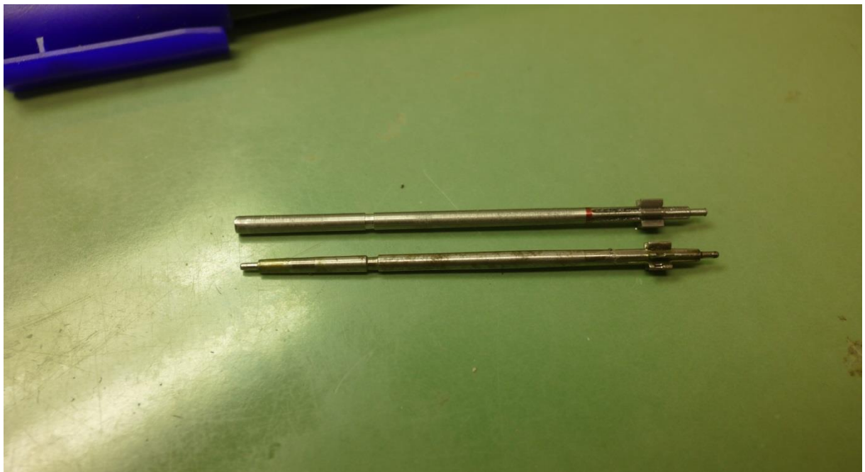
Vergleich: Alte Welle (unten) und neue Welle während der Entstehung
