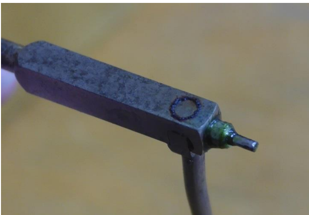
Ankerzapfen mit gealtertem (grünlichem) Öl
