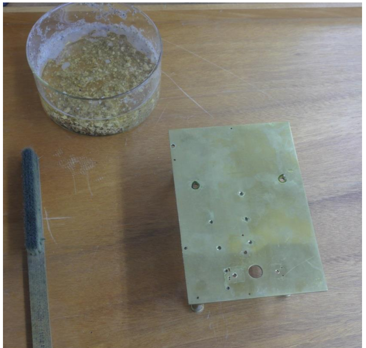
Handreinigung mit Seifenwurzellösung und Bürste
