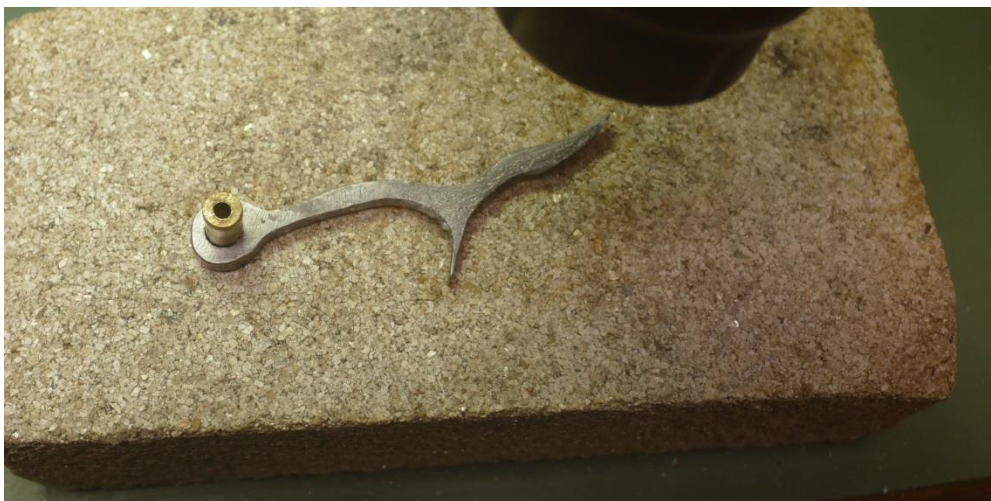
Wachsauftrag auf einem Hebel
