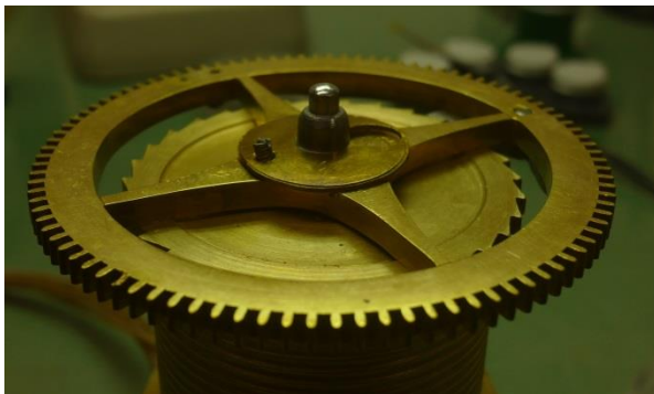
Einschrauben der Axialsicherungsscheibensicherungsschraube
