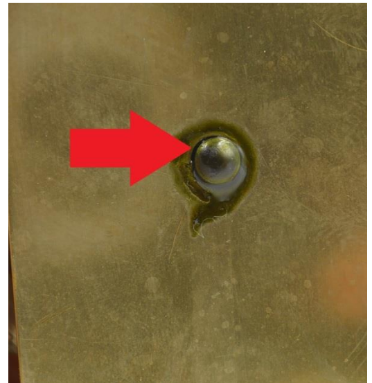
Ausgelaufenes Lager (sichtbar am zu großen Spalt)
