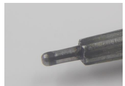
Zapfen mit Laufspuren (erkennbar: der Zapfen ist nicht mehr exakt zylindrisch, sondern in der Mitte eingelaufen)
