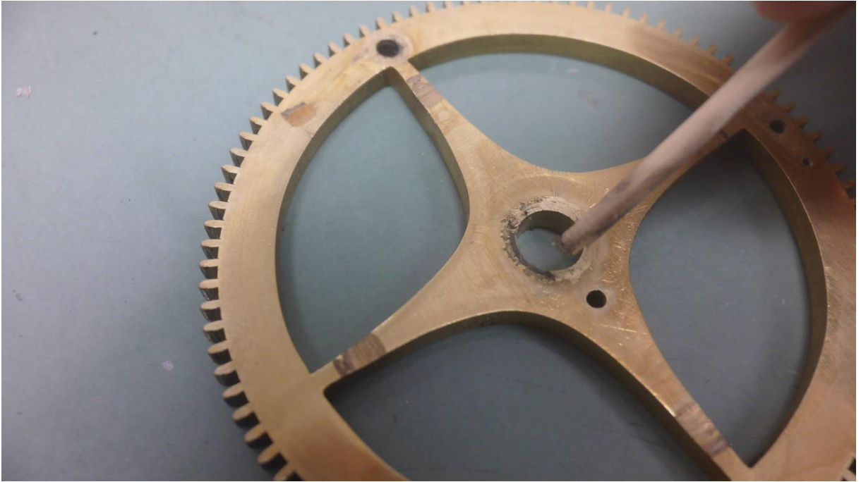
Hartnäckigem Schmutz, der nicht mit der Bürste zu entfernen ist, wird mit dem Putzholz begegnet
