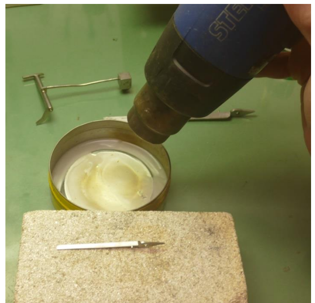
Erwärmen des Wachses mit dem Heißluftfön
