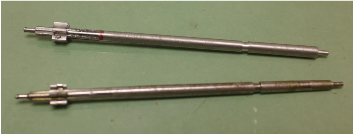
Altes Trieb (unten) und neues Trieb in seiner Entstehung
