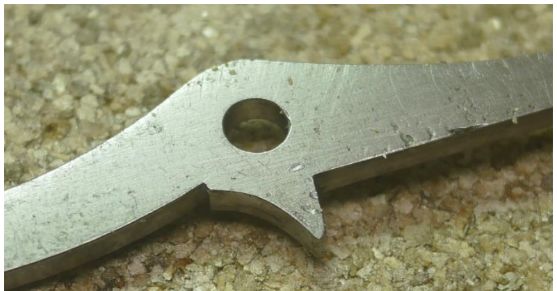
Feil- und Bearbeitungsstruktur an einem Hebel im Detail
