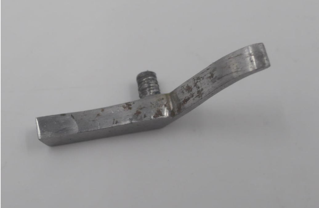
Roter Rost an der Sperrklinke
