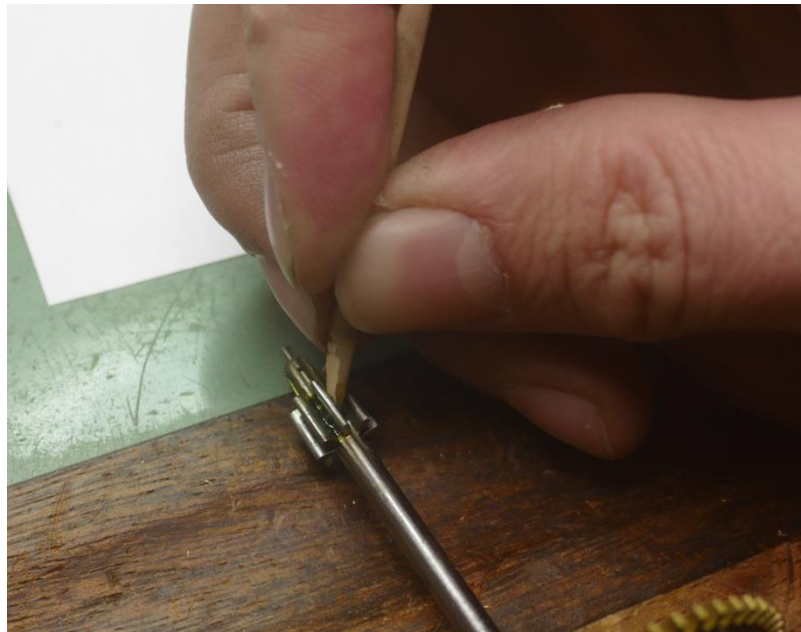
Arbeiten mit dem Putzholz
