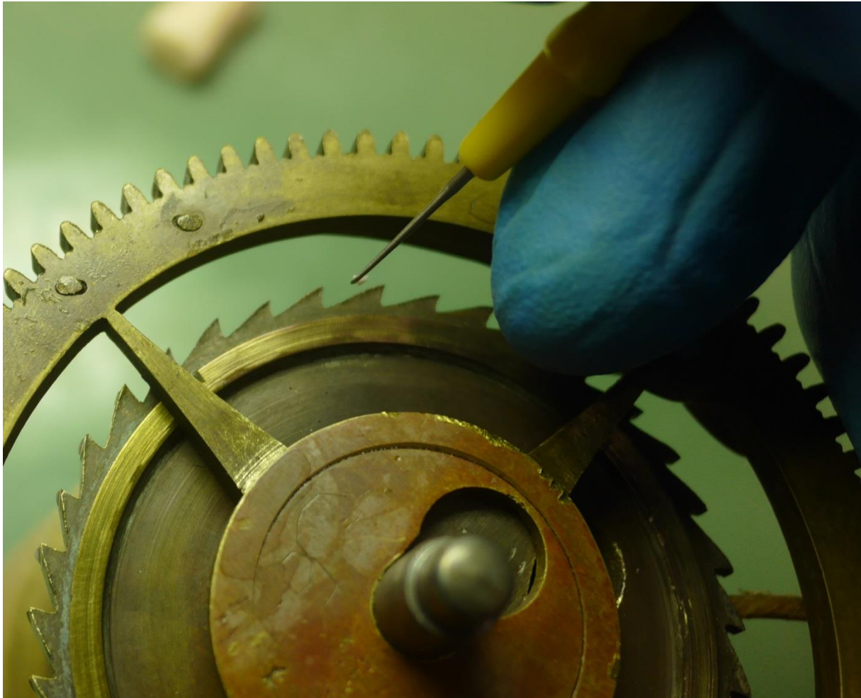
Auftragen von Fett auf die Sperrradzähne (mindert Reibung zwischen Sperrklinke und Sperrrad)
