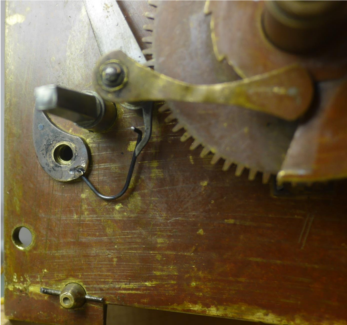
Zuletzt wird der federharte Stahl derart in Form gebogen, dass er seine Aufgabe sicher erfüllen kann.
