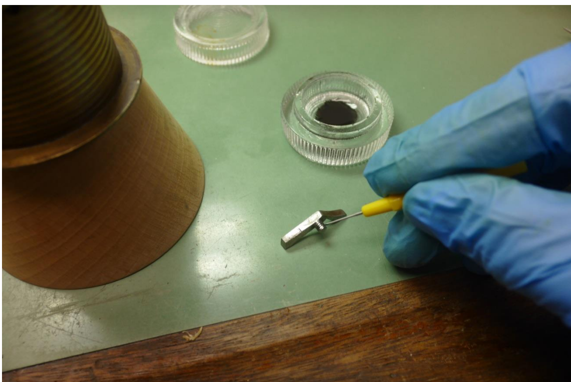
Das Gewinde (das hier als Lagerung fungiert) der Sperrklinke wird mit einem Graphitöl geschmiert
