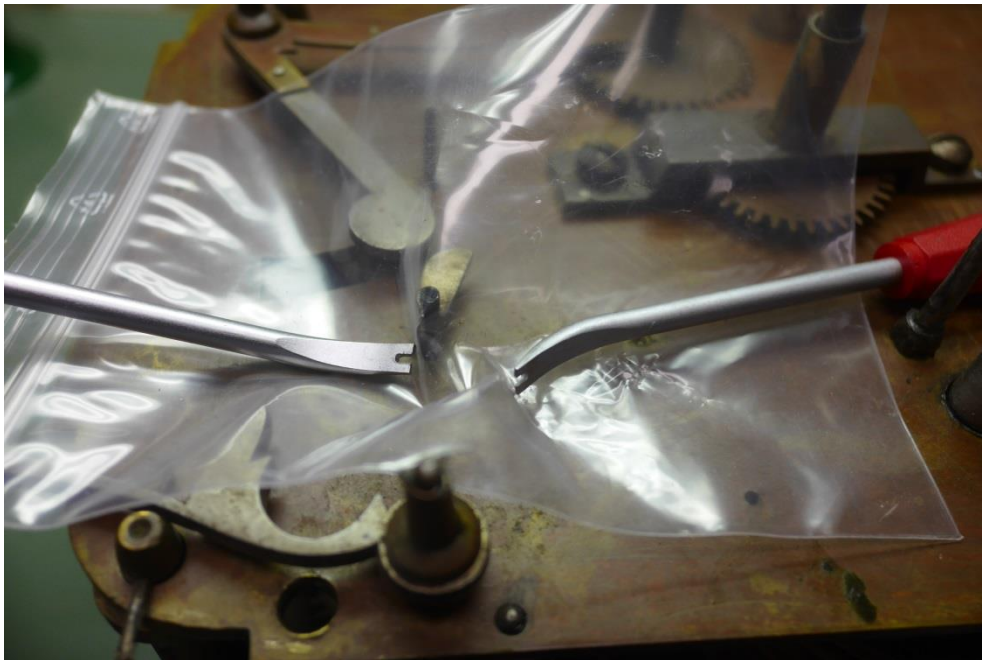
Aufgepresste Teile müssen abgehebelt werden, die Folie schützt hierbei die Platine vor Kratzern.
