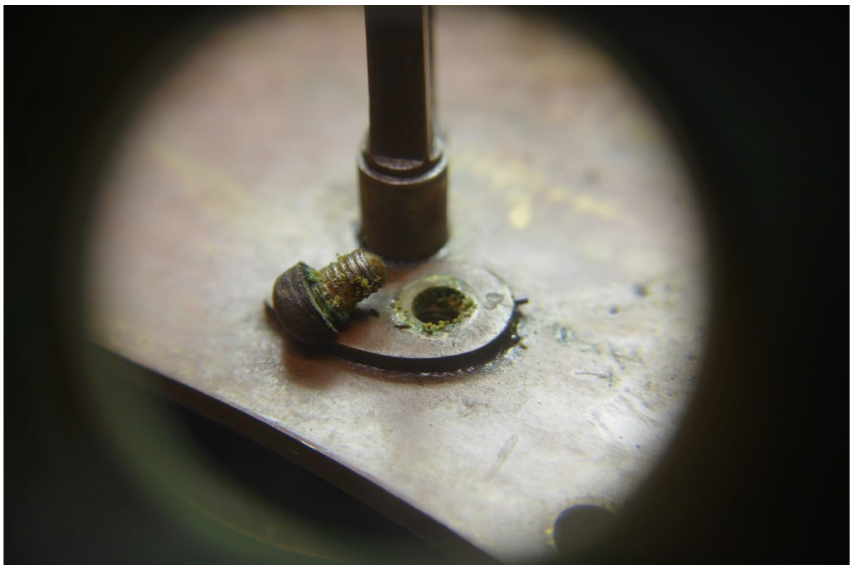
Verschmutzungen: die grünen Rückstände sind Korrosionsprodukte, die säurehaltige pflanzliche / tierische („Klaunenöle“) Uhrenöle im Laufe der Zeit bilden
