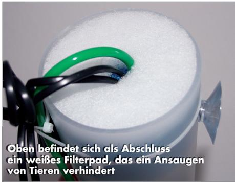
Oben befindet sich als Abschluss ein weißes Filterpad, das ein Ansaugen von Tieren verhindert
