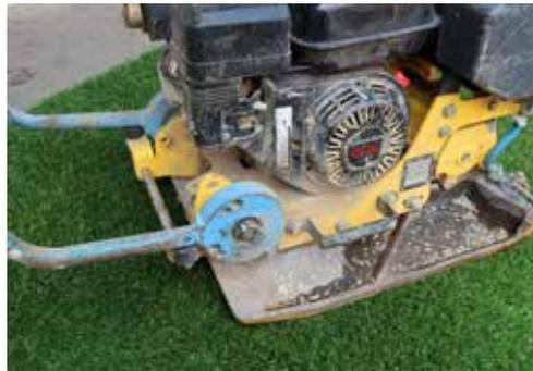
Planieren Sie die abgegrabene Fläche und verdichten Sie diese mit einer Rüttelplatte. Der Untergrund soll möglichst gerade und ohne Unebenheiten sein.
