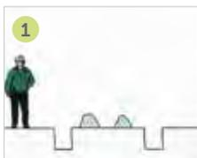
1 Marquez l'emplacement de votre future clôture. A l'emplacement des deux premiers poteaux, creusez un trou de 40 x 40 cm sur 50 cm de profondeur minimum (la profondeur varie en fonction de la hauteur hors sol de la clôture, de la nature du sol et de la force des vents).
