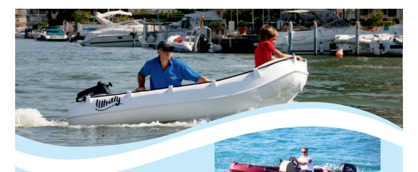
Les bateaux **Whaly** sont des bateaux à double paroi en une seule pièce, fabriqués à partir de matériau synthétique (polyéthylène, ou PE) par rotomoulage.
