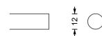
STA 12 P Handtuchstange Ø 12 mm auf Maß gefertigt. Abschlüsse plan gedreht und per Hand geschliffen.
