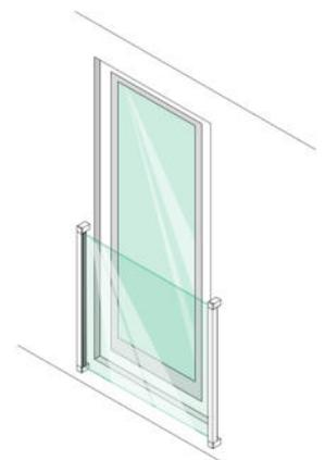
Installation an der Fassade mit vertikalem Vierkantröhr
