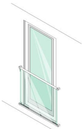
Installation an der Fassade mit horizontalem Rundrohr
