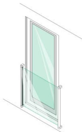
Installation an der Fassade mit vertikalem Rundrohr
