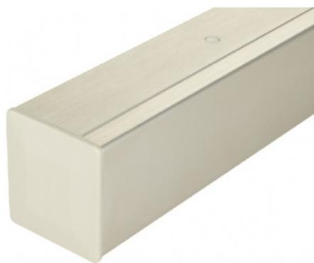
Die Laufschiene ist bereits mit Schraublöchern zur Wand- und Deckenmontage ausgestattet. Schraublochabstand 200 mm, Lochung für Senkschrauben 6 mm.
