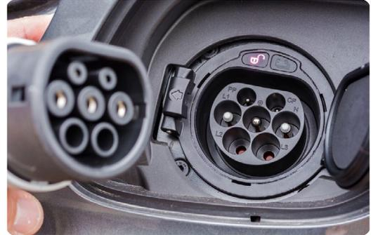
El conector Mennekes permite la carga desde los 6A hasta los 32A en monofásico y trifásico.
