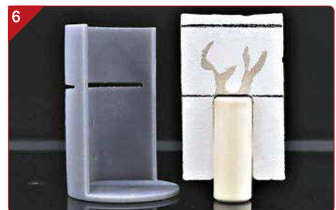
Aspecto interno en la marca de la línea de corte. Fácil separación del émbolo y eliminación del revestimiento en la parte superior
