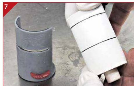
Proceso de corte de la parte media con separación perfecta del émbolo
