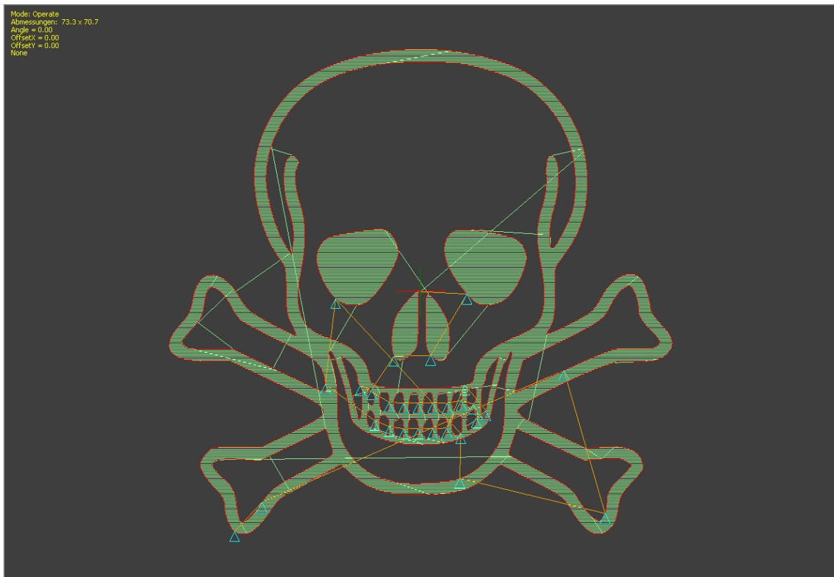
Abbildung 110: Berechnete Werkzeugpfad für den Laser
